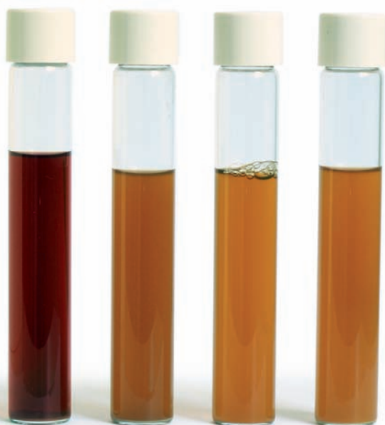
BfB-Bouillon für Bierschädlinge – jeweils mit 1 µl einer Übernachtskultur beimpft und mikroaerophil für maximal 72 Stunden bei 30°C inkubiert – v.l.: 1. unbeimpfte Kontrolle 2. Pediococcus damnosus WDCM 00022 3. Leuconostoc pseudomesenteroides DSM 20193 4. Pectinatus sp. Wildstamm
