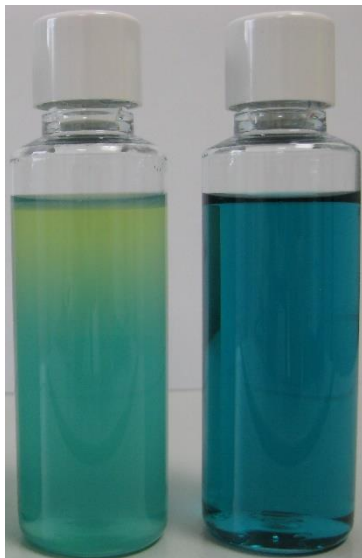
Links: Positivkontrolle Pseudomonas aeruginosa mit Farbumschlag und Kahmhautbildung oben auf Bouillon Rechts: Negativkontrolle beimpft mit Escherichia coli
